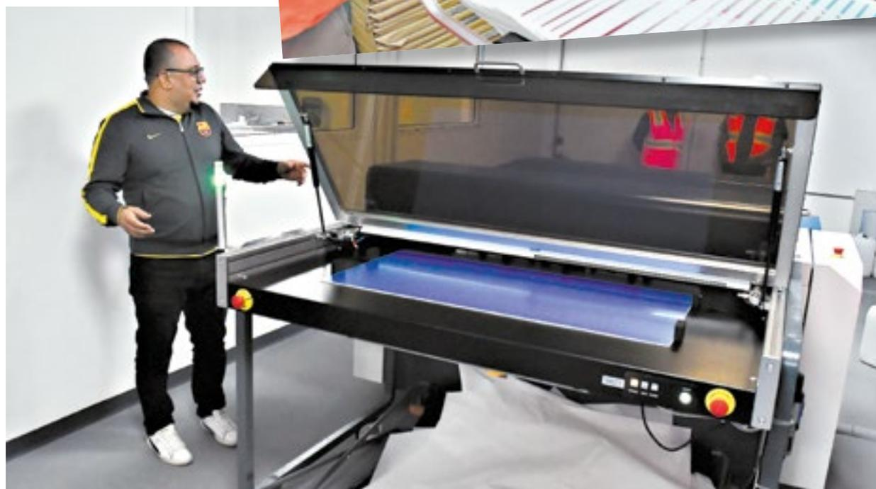
El Computer To Plate, CTP, es una de las nuevas adquisiciones: es lineal como una impresora que usa planchas metálicas que son grabadas por medio de un servidor.
