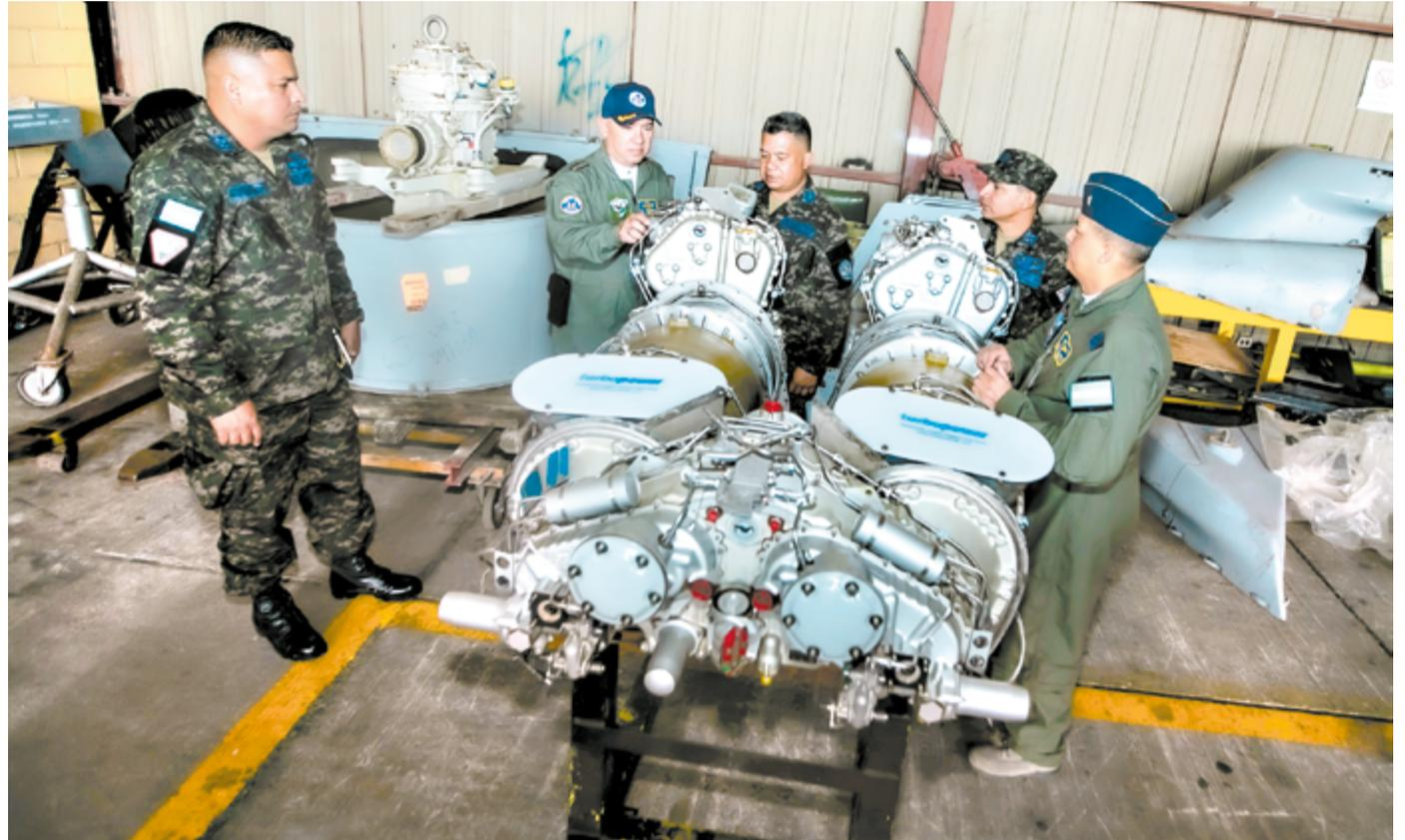
Parte de los motores que están siendo instalados en los helicópteros Bell 412 para dar mayor repotenciación a las horas de vuelo en la que se realizan misiones especiales.
